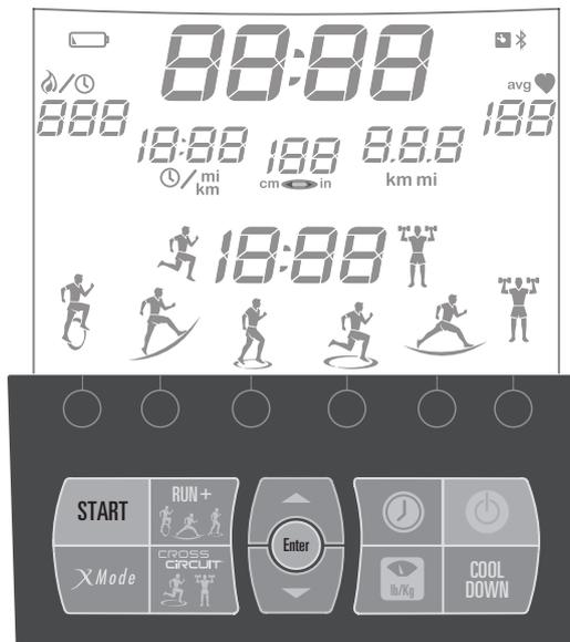
Используйте клавиатуру Zero Runner для программирования тренировки перед ее началом, изменения настроек в процессе тренировки или программирования тренировки с инструктажем в режимах RUN +, X-Mode и CROSS CIRCUIT.
